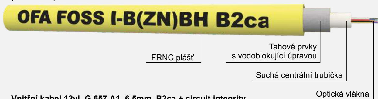
Vnitřní kabel 12vl. G.657.A1, 6,5mm, B2ca + circuit integrity, FOSS DB4678 FiberConnect - základní data kabelu
