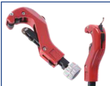
Rychle uvolnitelný řezák (6-42 mm) Okružní řezák pro HDPE trubky průměru 6-42mm s možností použití na trubky s již instalovaným kabelem. Řezák má integrovaný odhrotovač vnitřních hran.
