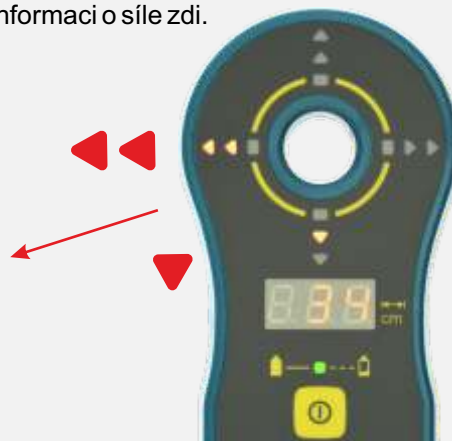
Nalezení polohy, měření tloušťky stěny
