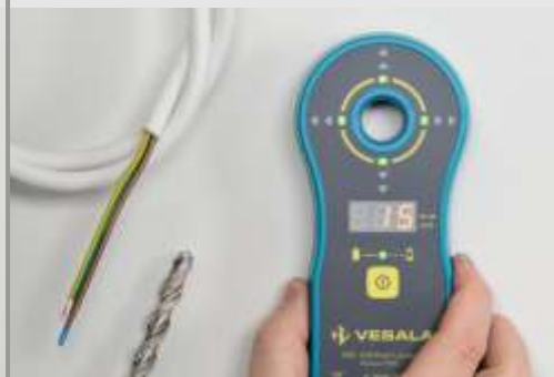
Nalezení polohy, měření tloušťky stěny
